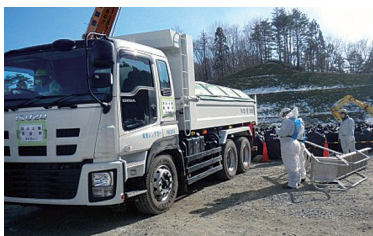
車両の放射線量率の測定
